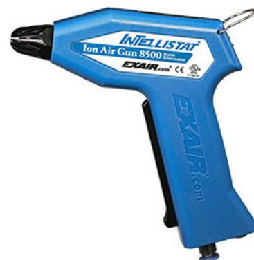
Utilizzano aria compressa ricca di ioni per neutralizzare la corrente elettrostatica e rimuovere il particolato e la polvere su prodotti durante i processi di lavorazione, assemblaggio, confezionamento. Con una tensione di lavoro di +/- 30 Volt è sicura per l'uomo, emette un getto di aria molto ricco di ioni in grado di ridurre la carica sulle superfici da 5000 Volt a meno di 500 Volt in meno di un secondo. Dotata di alimentatore da 100-240 Volt a 24 Vdc.
