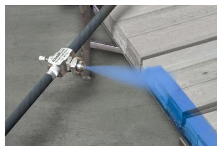
Gli ugelli atomizzatori Exair miscelano fluidi (spesso acqua) ed aria compressa per spruzzare-atomizzare su componenti e pezzi in lavorazione e/o nell'ambiente. Disponibili con attacchi G 1/8" 1/4" 1/2" in 3 diverse famiglie come specificato sotto, con ulteriore suddivisione in tipologie di flusso in uscita, costruiti in acciaio inossidabile.
