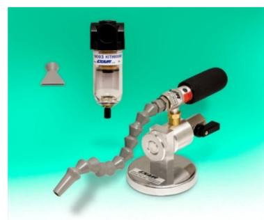
Producono un getto di aria fredda fino a 30°C inferiore alla temperatura dell'aria compressa in ingresso. Progettati per evitare il surriscaldamento degli utensili e dei pezzi in lavorazione, indicati anche nelle operazioni di cucitura veloce su materiali sintetici che possono surriscaldarsi ed incollare l'ago.
