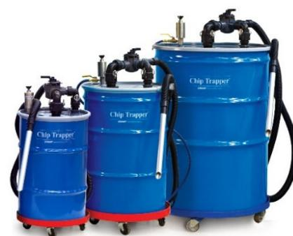
Tramite un capiente filtro a manica posizionato all'interno del fusto, Chip Trapper trattiene i solidi durante l'aspirazione, separandoli dal lubrificante che può essere pompato ripulito nella vasca della macchina.
