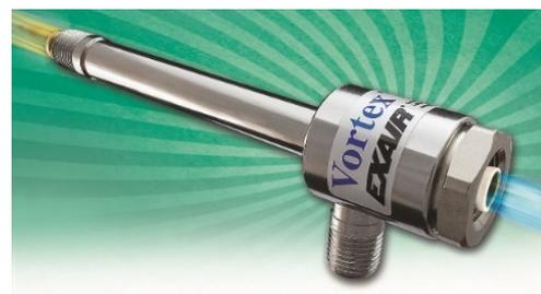
I tubi a vortice sfruttando solo aria compressa, generano 2 flussi di aria, uno freddo ed uno caldo, senza parti in movimento. Raggiungono temperature da -46°C a +127°C.
