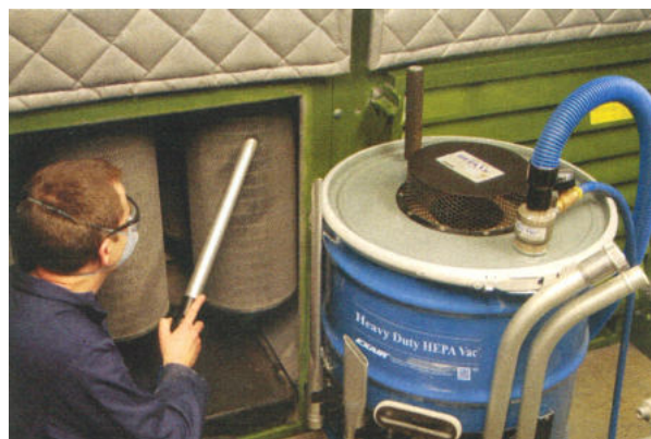
Pulizia di filtri intasati dalla polvere utilizzando l'aspiratore Heavy Duty HEPA Vac
