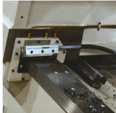
Rimozione trucioli da guide di scorrimento di macchina utensile
