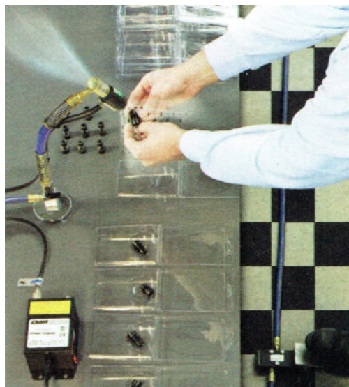
Stay Set Gen4 Ion Air Jet codice 8194-9362 rimuove la polvere da componenti prima del confezionamento in blister
