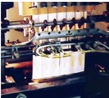
Standard air Knife apre sacchetti per confezionamento
