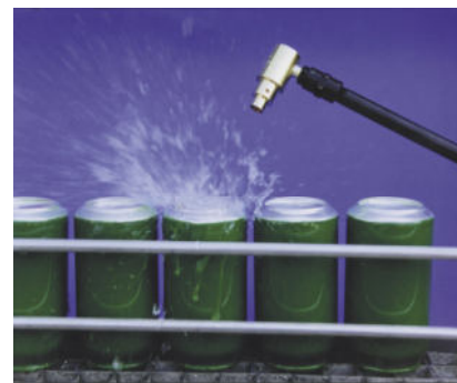
Getto ad alta velocità d'aria Air Jet 6013 utilizzato per asciugare lattine di alluminio
