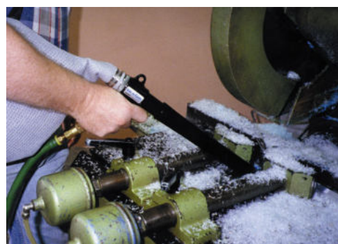
Kit Collection System 6192 aspira polvere di plastica
