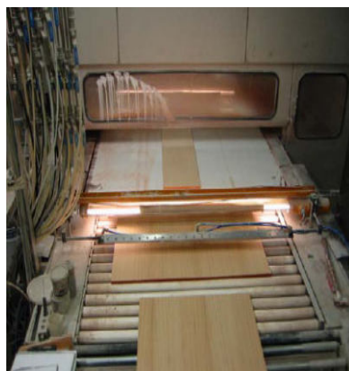
Pulizia pannelli di legno prima della verniciatura
