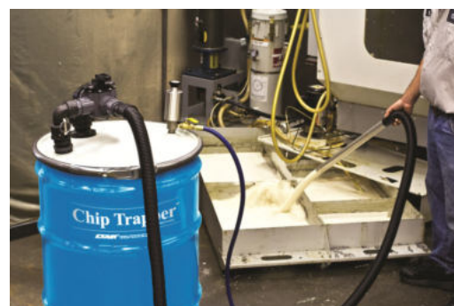
Emulsione filtrata da Chip Trapper
