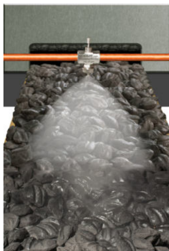
Il modello AW1030SS abbatte la polvere durante la produzione di carbone
