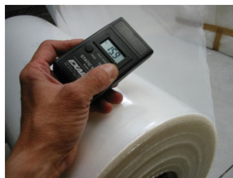
Rilevazione di cariche elettrostatiche su film termoretraibile
