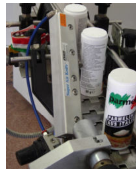
Pulizia contenitori per alimenti prima dell'etichettatura
