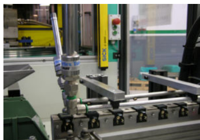
Raffreddamento di bobine per elettrovalvole dopo la saldatura
