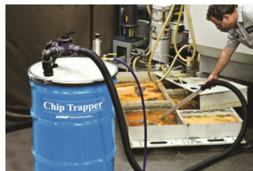
Trucioli ed emulsione nella vasca della macchina
