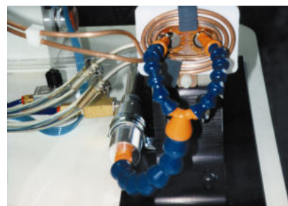
Raffreddamento trafilatura per produrre tubetti uso medicale
