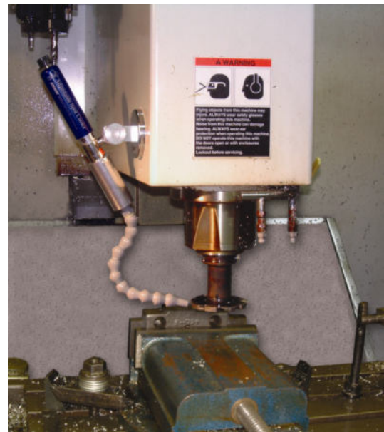
Raffreddamento in fresatura
