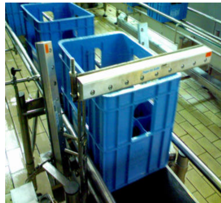
Asciugatura cassette di plastica per acqua minerale
