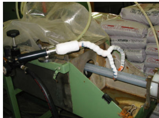
Raffreddamento di tubi dopo l'estrusione
