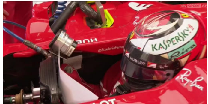
Amplificatore Exair cod 6042 che soffia aria sul pilota durante una pausa ai box
