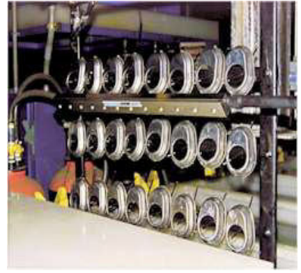
Asciugatura pezzi dopo il lavaggio e sgrassaggio
