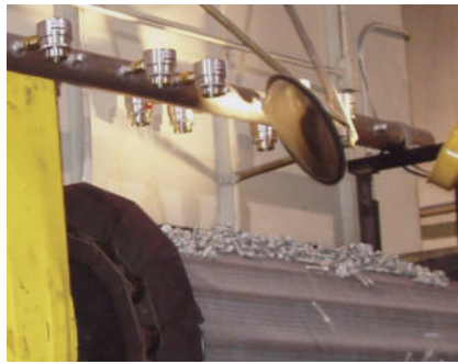
Amplificatori cod 6042 asciugano pezzi dopo il lavaggio
