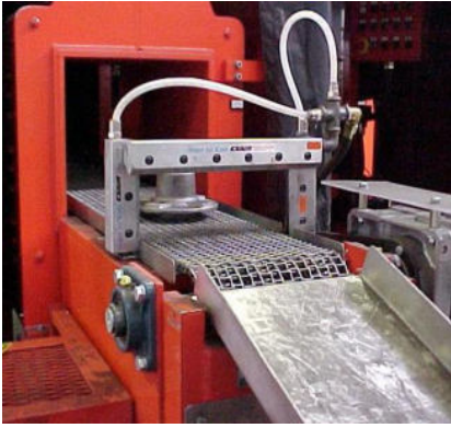
Rimozione trucioli e liquidi da pezzi in lavorazione
