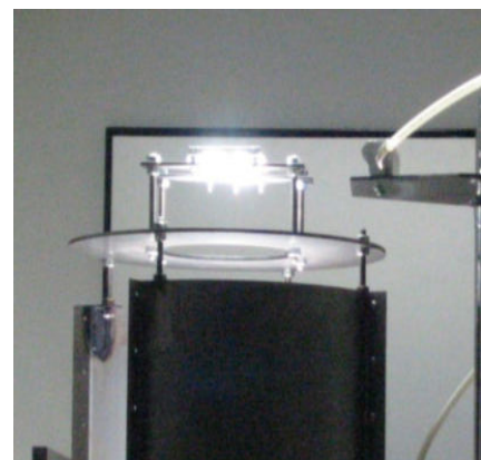
Raffreddamento lampada e filtro per simulatore solare
