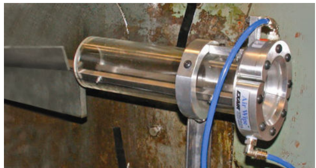
Standard Air Wipe pulisce dal liquido e residui di lavorazione pezzi che passano attraverso il dispositivo
