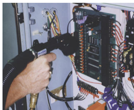
Vac-U-Gun con spazzola per aspirare polvere
